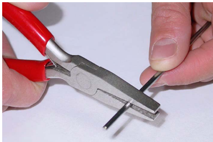
Fig.37: Piegare l'estremità dell'asta di rinvio.
