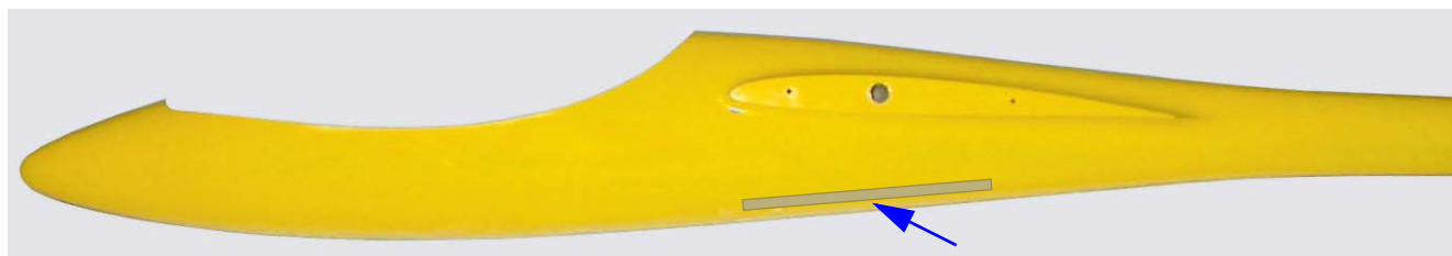
Fig.47: Posizione del listello di rinforzo interna alla fusoliera (vista in trasparenza).
