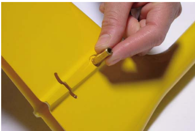
Fig.17: Inserire parzialmente la boccola.
