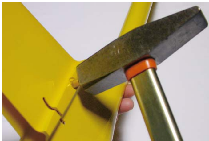
Fig.23: Picchiare sulla boccola per inserirla.
