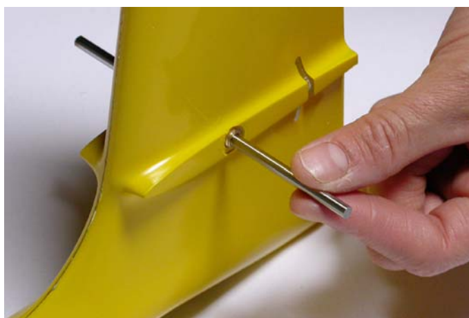
Fig.25: Inserire la baionetta dei piani di coda.
