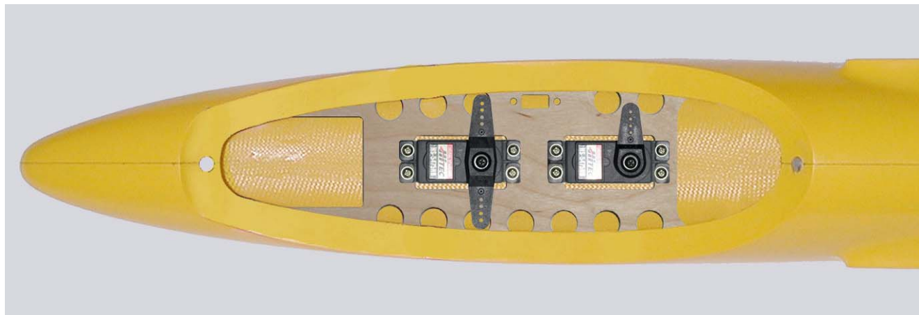
Fig.53: Montare stabilmente i servocomandi.
