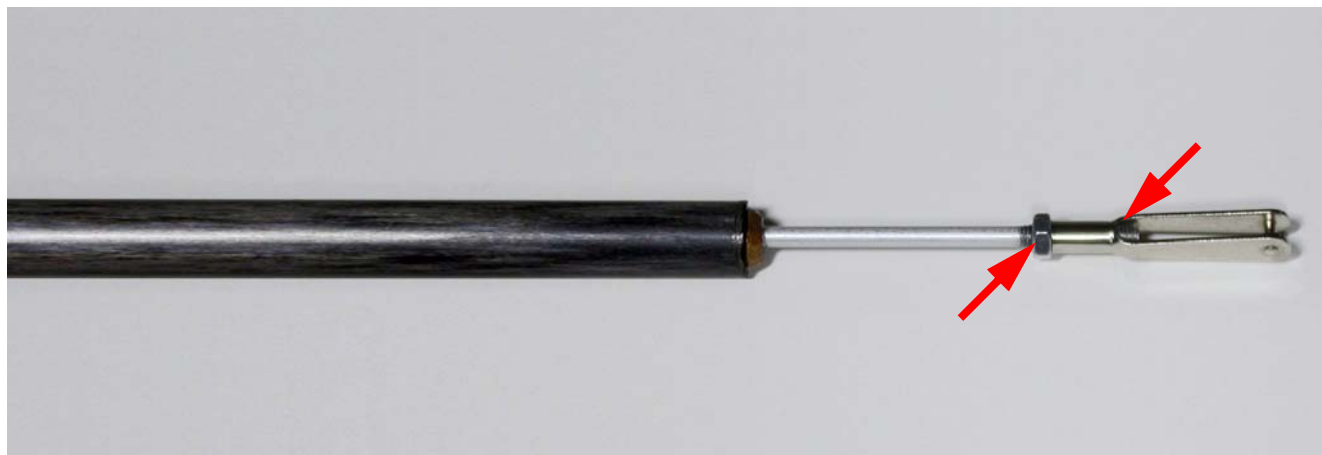
Fig.14: Incollare i punti indicati.
