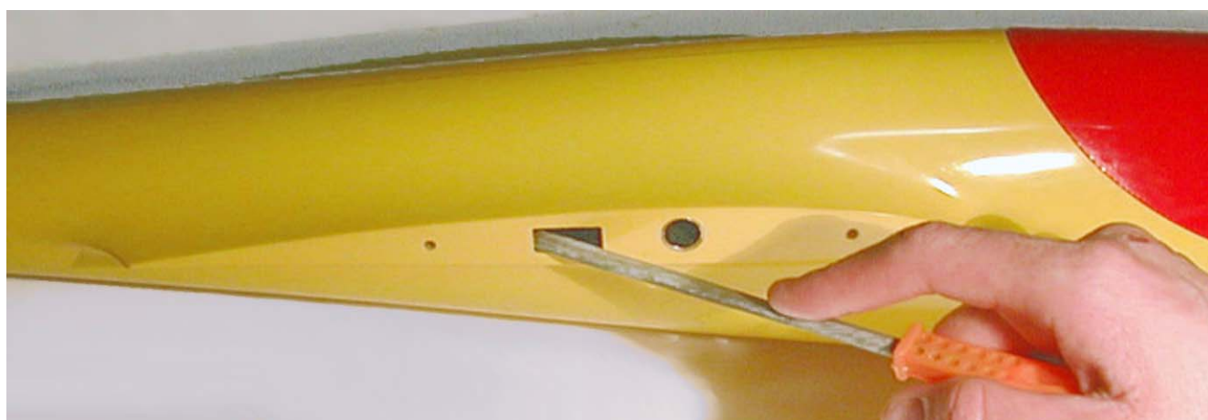
Fig.44: Allargare il foro rettangolare per far passare il connettore dei servocomandi alari.
